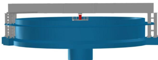
23. Установить кронштейн из угловой стали, закрепив его к раме моста при помощи болтов, поднять успокоитель, отрегулировать его положение и приварить к кронштейну из угловой стали.
