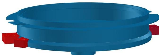
3. Демонтировать транспортировочный поддон центральной секции рамы моста.
