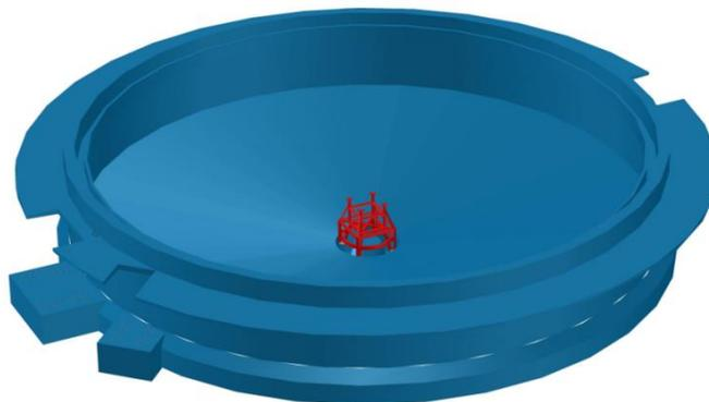
13. Поднять нижнюю часть приводного вала и соединить его со вспомогательной гребковой рамой.
