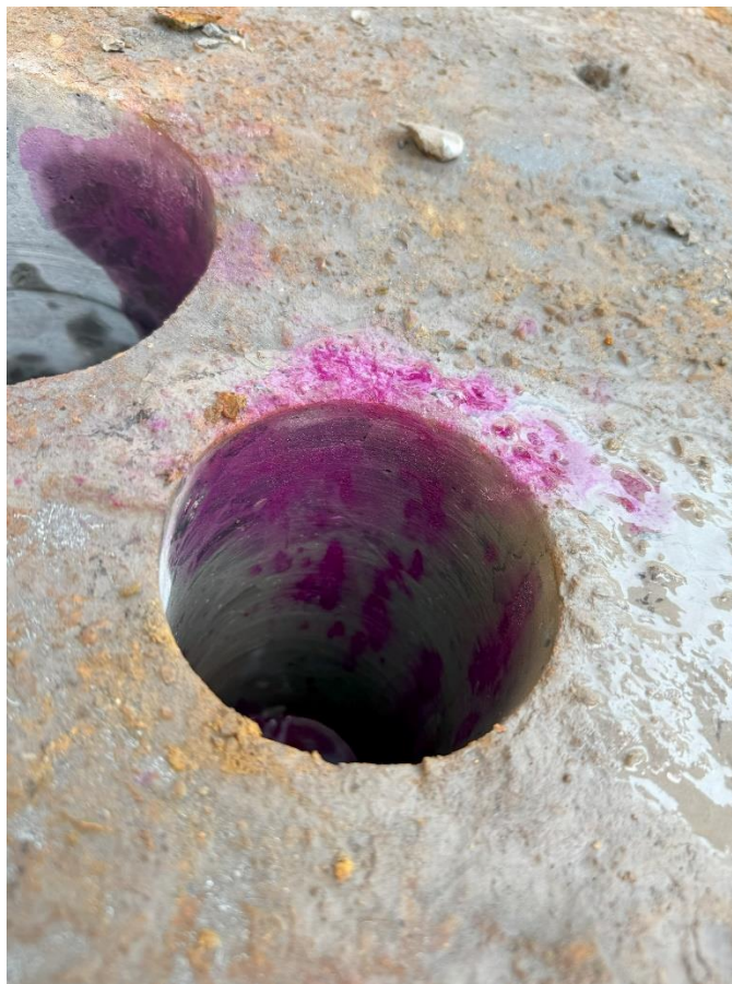
Рисунок 5.1.20. Проверка карбонизации в месте изъятых кернов. До 10мм
