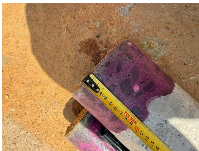
Рисунок 5.1.18. Глубина карбонизации до 10мм, керны №1.
