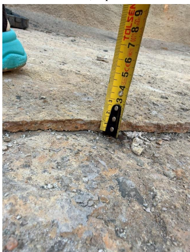
Рисунок 5.1.19. кислотоупорное покрытие 3...10мм
