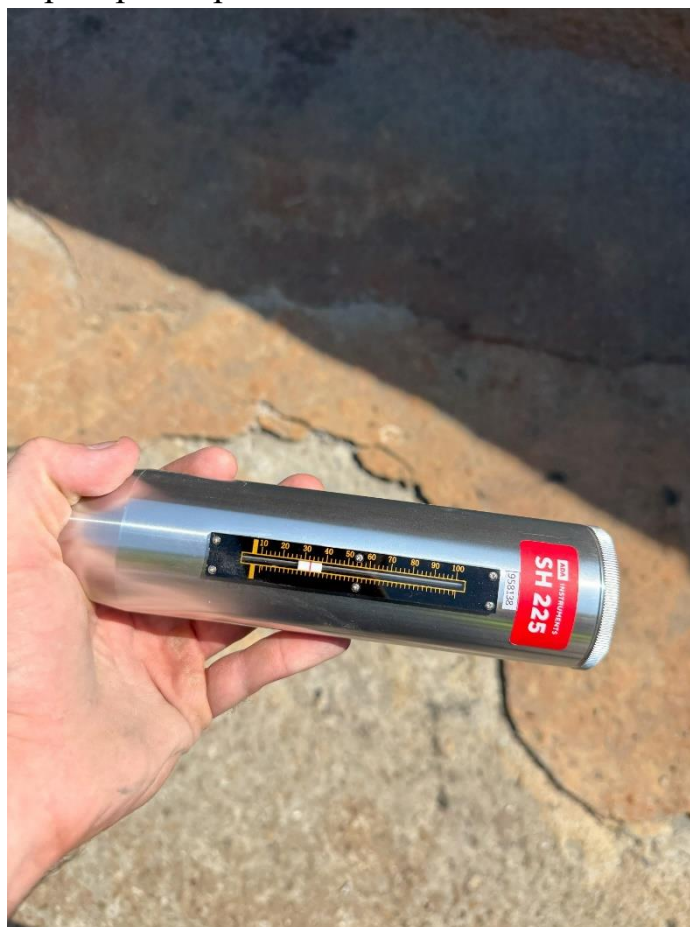
Рисунок 5.1.21. Определение прочности бетона неразрушающим методом
