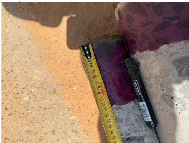
Рисунок 5.1.18. Глубина карбонизации до 10мм, керны №1.
