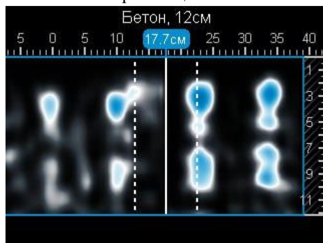
Рисунок 5.1.31. Расположение армирования по наружной стороне днища чаши (радиальное загрузление аромивания). Защитный слой 10...15мм. Шаг 110...140мм
