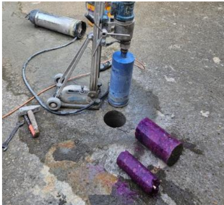
Рисунок 5.1.19. Глубина карбонизации до 10мм, керны №5
