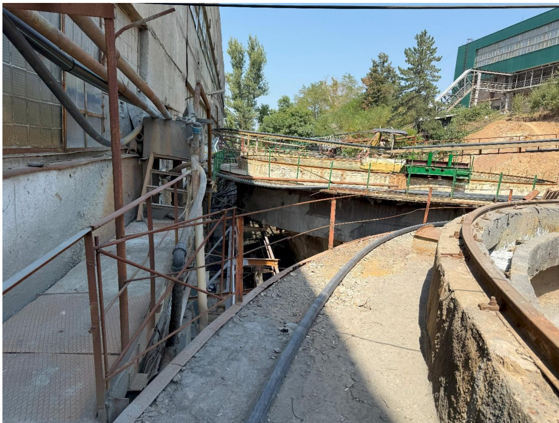
Рисунок 5.1.16. Ограждение ходовой площадки сгустителя
