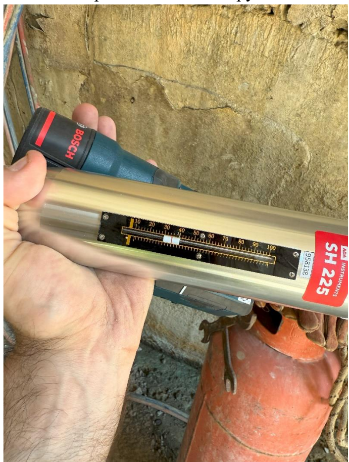
Рисунок 5.1.21. Определение прочности бетона неразрушающим методом
