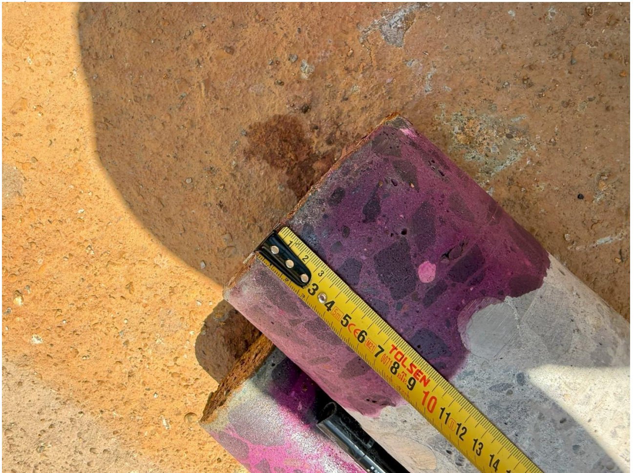
Рисунок 5.1.18. Глубина карбонизации до 10мм, керны №3.
