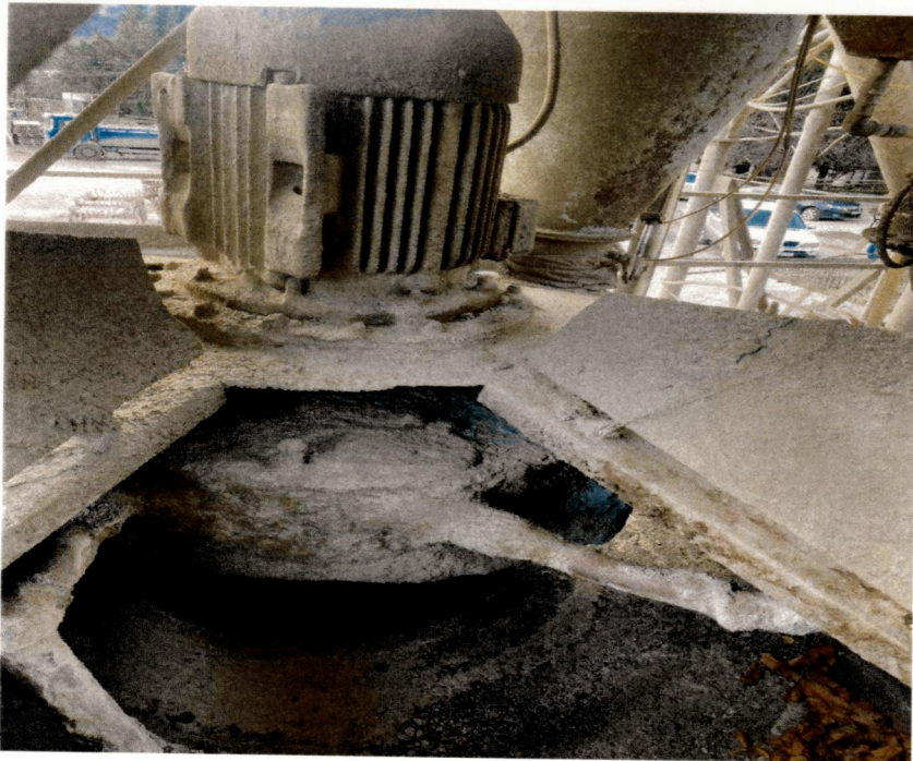
ბეტონის ამრევი SB-138. მოცულობა 1.5მ 3 (ძრავი 37კვტ/940 ბრნ.წუთი) 1ცალი
