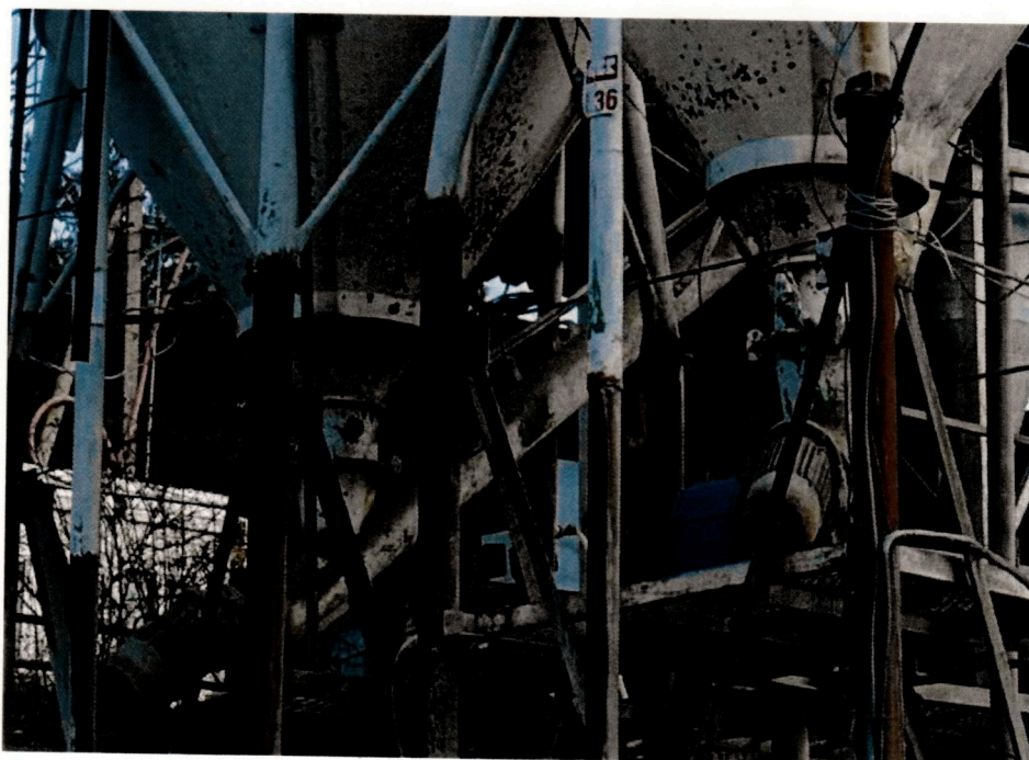
ცემენტის მიმწოდებელი დიამეტრი 220მმ. სიგრძე 4 მ.(შნევი) 2ცალი (ძრავ/რედუქტორი 5.5
